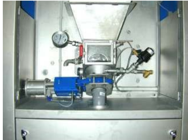
Mischkammer mit automatischer Entflottung
