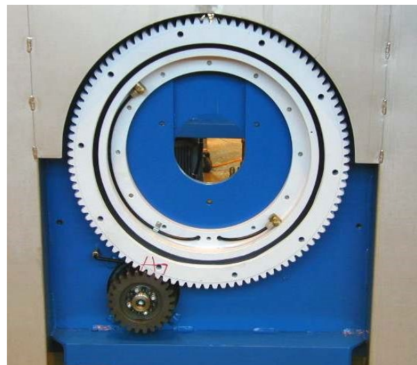
Motorhalteplatte mit Zahnradantrieb und Zahnkranz
